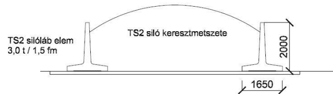
T-támfalas vasbeton silóelemekből kialakított tárolótér (Elemhossz 1,5 méter)
