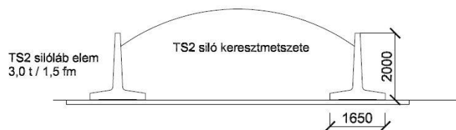
T-támfalas vasbeton silóelemekből kialakított tárolótér (Elemhossz 1,5 méter)
